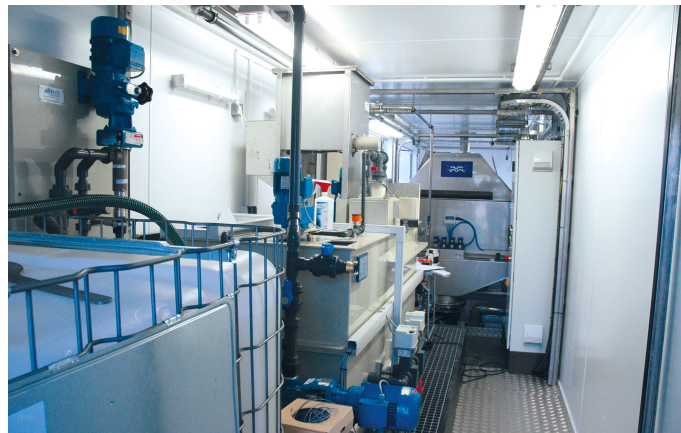
02 Neben dem Bandeindicker enthält der Container alles, was für eine effiziente Schlammwässerung benötigt wird: darunter sind Steuerkasten, Polymersysteme und andere Hilfssysteme
