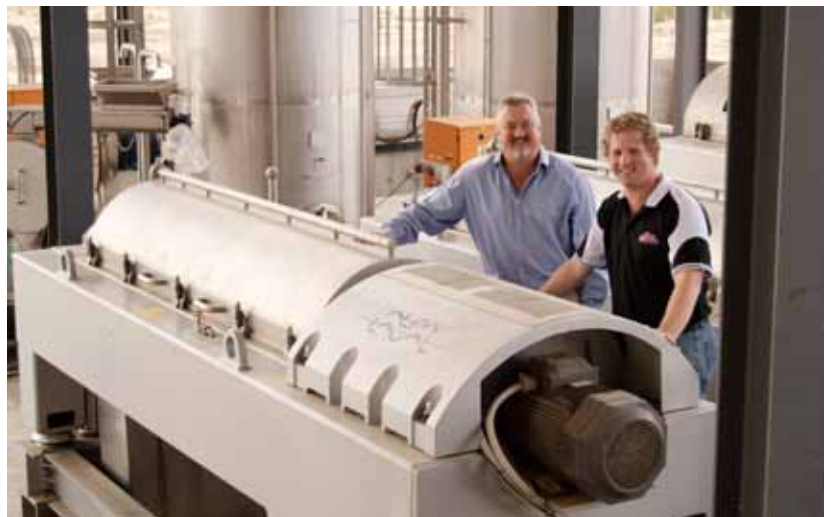
Mit vier großen Foodec-Dekantern von Alfa Laval hat Namaqua das weltweit größte Dekanterzentrifugensystem für Wein installiert.
