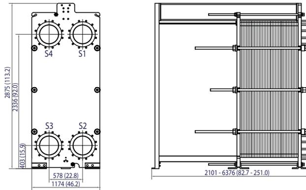
Die Anzahl der Spannbolzen kann je nach Druckauslegung unterschiedlich ausfallen.
