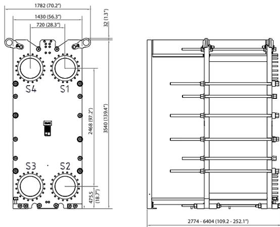
Die Anzahl der Spannbolzen kann je nach Druckauslegung unterschiedlich ausfallen.
