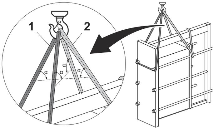
Abbildung 5: Die Abbildung zeigt die Einfädelung der Hebegurte.
