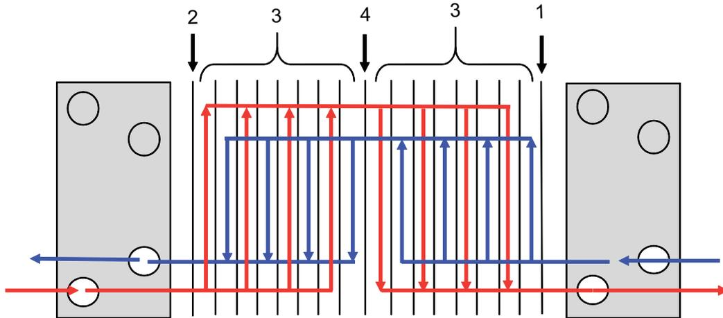
Abbildung 4: Beispiel eines Setups mit mehreren Durchgängen.
