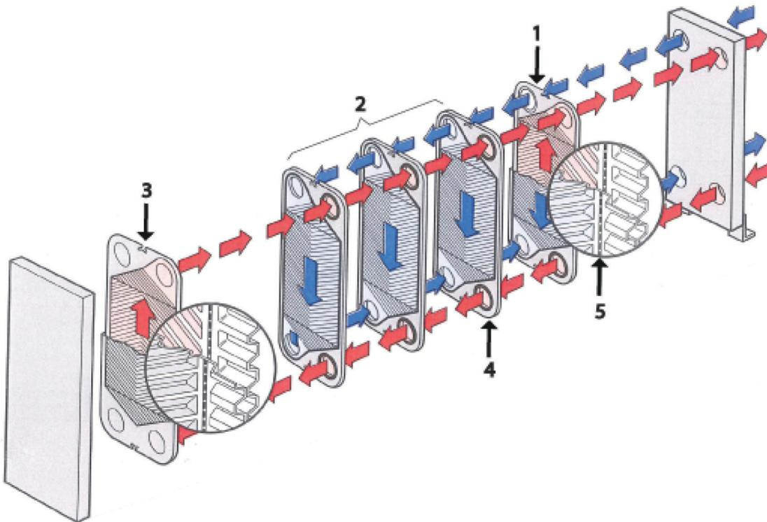
**Abbildung 2: Beispiel einer Konfiguration mit einem Durchgang**
