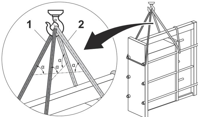
**Abbildung 4:** Die Abbildung zeigt die Einfädelung der Hebegurte.
