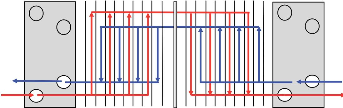
Abbildung 3: Beispiel eines Setups mit mehreren Durchgängen.
