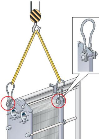
**Abbildung 8: Anheben des Semi-verschweißter TK20 und Semi-verschweißter T20.**
