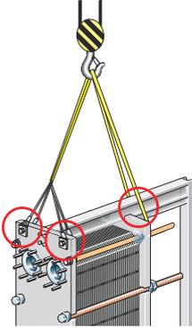
**Abbildung 7: Anheben des Semi-verschweißter MK15.**
