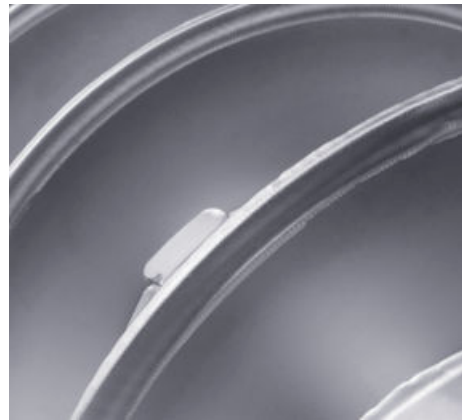
Abbildung 6. Verschleißschutz der Schnecke als Wolframkarbid-Auftragsschweißung
